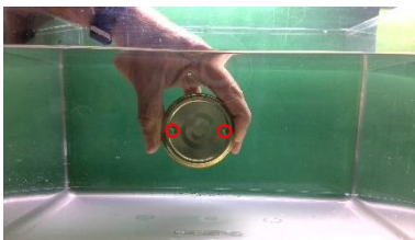
Abbildung 4: Löcher auf gleicher Tiefe
