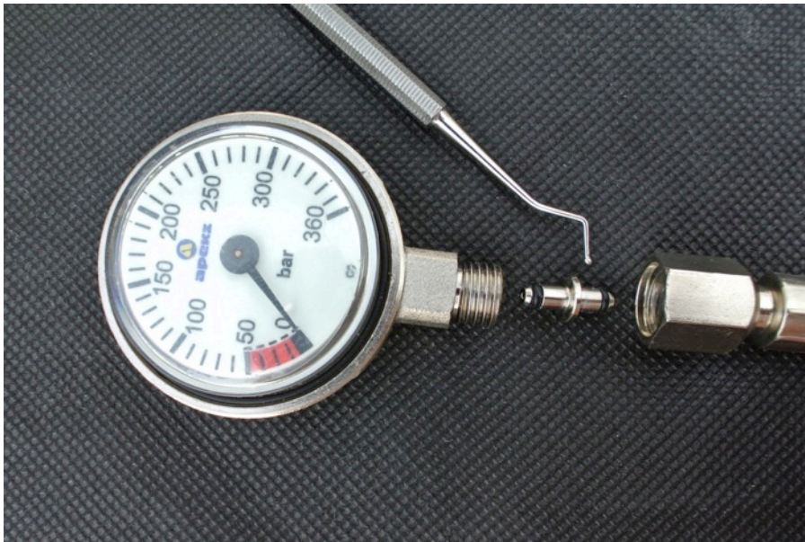
Bild 3: Wenn der Manometer am Drehgelenk (Swivel) abbläst: O-Ringe verschlissen - Soforthilfe: Manometer soweit drehen, bis Blasenspur beendet.
