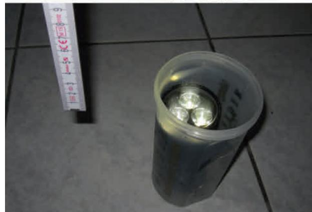
Zu Beginn des Versuchs wird die Anordnung auf maximale Beleuchtungsstärke justiert. Bis zum Ende der Brenndauer darf ab dann nichts mehr bewegt werden, damit die Werte der Messreihe untereinander vergleichbar bleiben.
