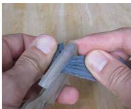
**Schnittprobe bei einer stumpfen Klinge. Bei ausreichender Schärfe wird das Material mit wenig Kraft und ohne größere Faltenbildung durchtrennt.**
