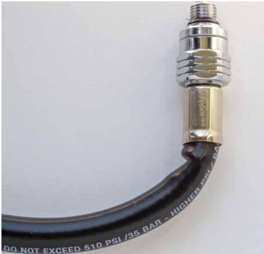
letzten Jahren wiederholt neue Schlauchmaterialien auf den Markt. Die Hersteller versprochen stets Vorteile für uns Taucher: flexibler, gut zu verlegen, viele Farben etc. Doch die Zwischenfälle durch defekte Mitteldruck- und Hochdruck-Schläuche am Atemregler nehmen gefühlt zu. Sparen die Zulieferer auf Kosten der Tauchsicherheit? Dies möchten wir genauer untersuchen und starteten in Tauchlehrerkreisen eine online Umfrage, bei der schon über 100 engagierte TL-Kolleginnen und -Kollegen
